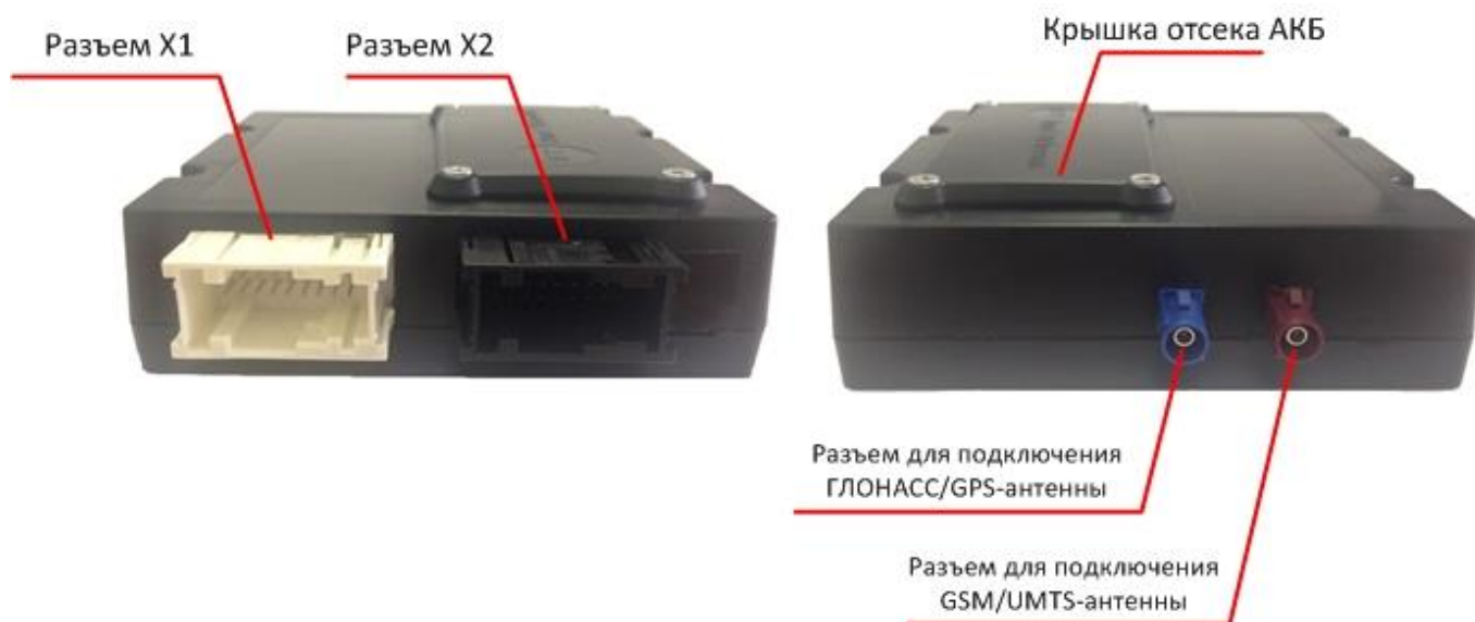
Рисунок 3.1. Внешний вид терминала FORT-112EG
